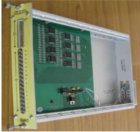
Fig. 7 : 16 channel NIM- ECL translator module
